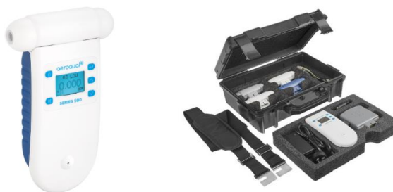
სურათი 4-4 „Aeroqual“ ბრენდის ჰაერის საზომი აპარატი
