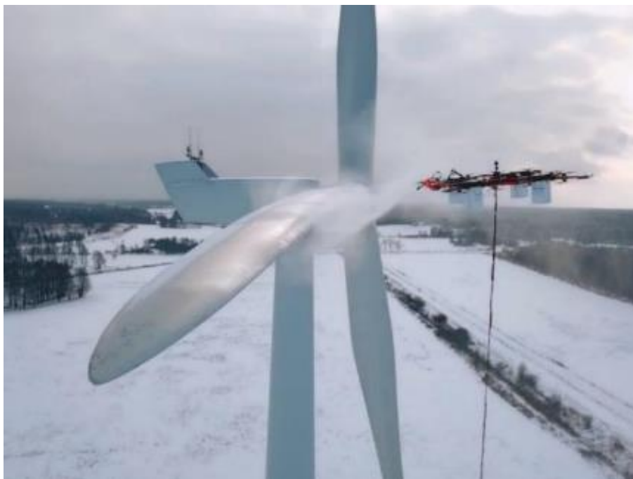
სურათი 5-39 დრონის გამოყენება ქარის ტურბინის გასაწმენდად
